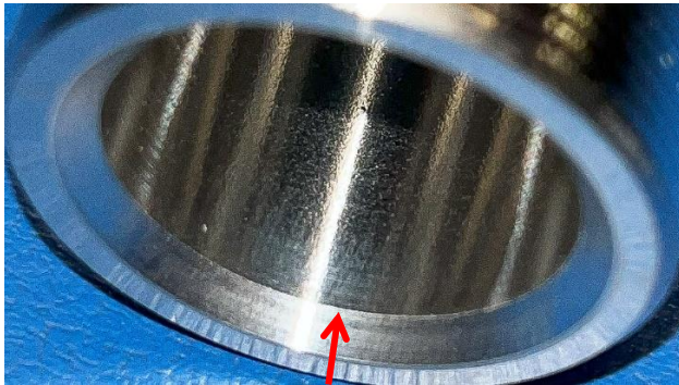
FIGURE 3: INCORRECT SHARP EDGE
