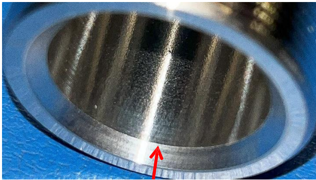
FIGURE 3: INCORRECT SHARP EDGE
