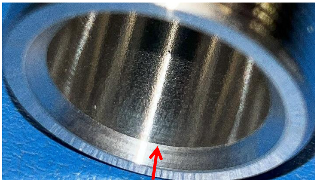
FIGURE 3: INCORRECT SHARP EDGE
